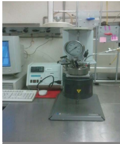
Fig. 1: Fotografía del reactor comercial tipo slurry, modelo Parr 4842.
