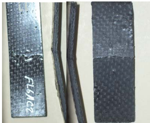
Fig. 3: Fotografías de tres probetas ensayadas a flexión, mostrando los daños producidos durante el ensayo. Muestra 60P.
