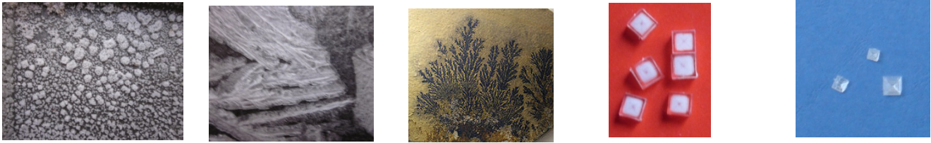
Fig. 3: Sal en una bandeja plana dos tipos (aspecto musgoso y aspecto arborescente, sal dendrítica, en el seno de urea, en el seno de azúcar (de izquierda a derecha).
