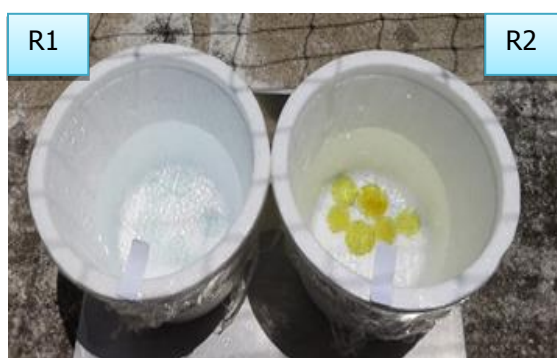
Fig. 4: Arreglo experimental destinado a la "cosecha de energía". Recipiente ubicado a la izquierda (R1): discos de vidrio sin AgNPs. Recipiente ubicado a la derecha (R2): discos de vidrio con AgNPs.
