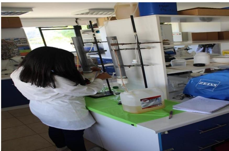
Fig. 9: Sistema de biolixiviación por micro columnas en fase inversa, se observa que la solución lixiviante ingresa por la parte inferior de la columna y sale por la parte superior, creando un sistema de inmersión del mineral.
