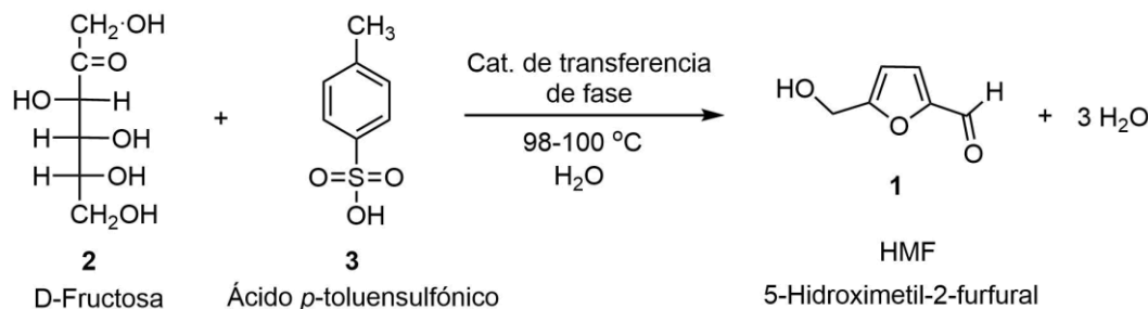
Fig. 3: Reacción de obtención de 5-hidroximetil-2-furfural (HMF).
