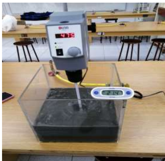
Fig. 4: Lixiviación química del relave mineral, es importante mencionar, que esta se realiza en una celda de lixiviación, diseñada para laboratorio metalúrgico (Fuente: Elaboración propia).
